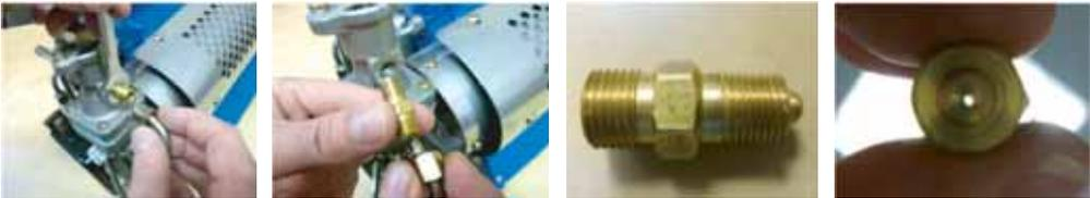
Se examina la manguera de combustible localizado en la parte derecha del depósito del combustible. Se examina que no hay fugas de aire y que el tapón del depósito está cerrado firmemente. Se desatornilla el inyector de combustible localizado en el lado del carburador con una llave inglesa de 12mm. Se limpia el inyector con aire comprimido para quitar cualquier bloqueo.
